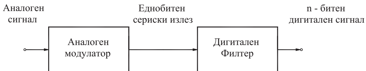
Сл. 8-31. Блок дијаграм на сигма – делта А/Д конвертор
